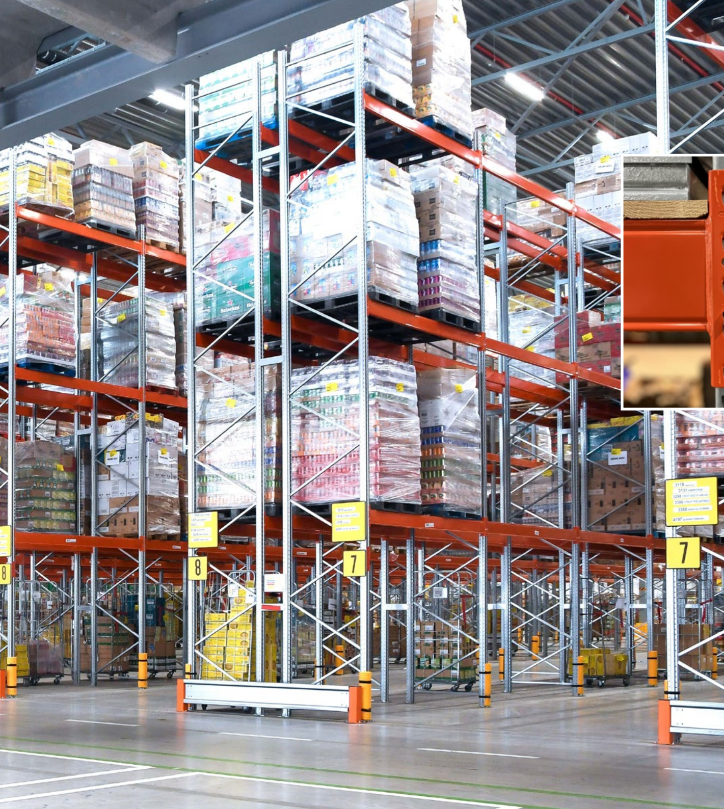
Bevestiging met een borgpen van de liggers in de staander van een palletstelling
